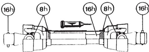
Démonter les 2 tubes pour bien graisser. Utiliser une graisse qui ne gèle pas. Les tubes de l'arbre de commande doivent glisser facilement même par temps froid. Au besoin, nettoyer la vieille graisse durcie et la remplacer par de la graisse neuve.
