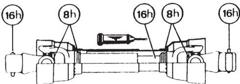
Démontez les deux tubes pour bien graisser. Utilisez une graisse qui ne gèle pas. Les tubes de l'arbre de commande doivent glisser facilement même par temps froid. Au besoin, nettoyez la vieille graisse durcie et remplacez-la par de la graisse neuve.
