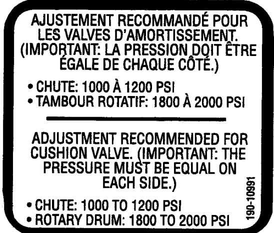
Figure 14 Autocollant G Pièce no.: 190-10991
