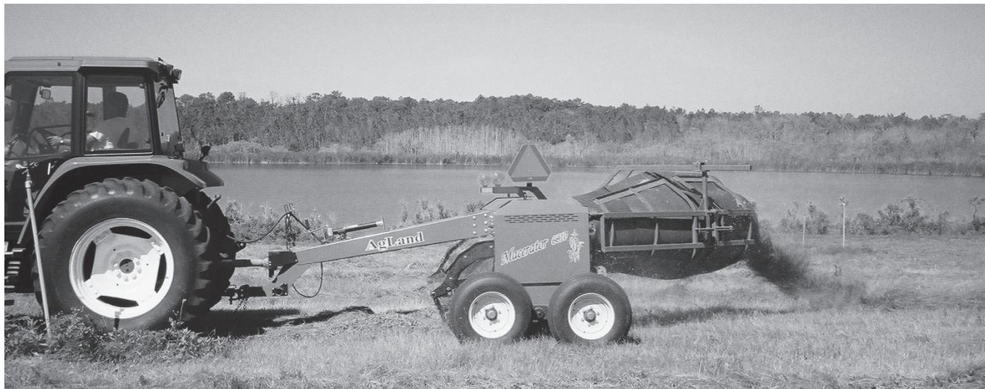
Le Macerator est conçu pour conditionner le fourrage pour un séchage super rapide tout en gardant la couleur et le maximum de substances nutritives. Le Macerator utilise des rouleaux d'acier spéciaux, dont chacun fonctionnant à une vitesse différente, permet à la tige d'avoir des entailles contrôlées, ce qui assure une plus grande aération du fourrage. Le ramasseur, à profil bas, permet une opération rapide avec un minimum de perte de feuilles.
