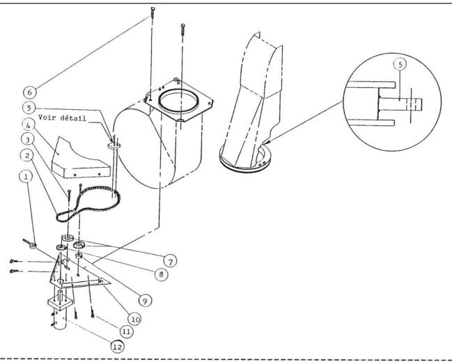
Numéro Pièces Réf. Description Qté. 1 8101 Tendeur 1 Chaîne no. 50" x 63" Boulon 5/8" NC x 3" lg + écrou 2 8102 1 3 Std. 2 et rondelle de blocage 4 8103 Garde-chaîne 1 5 8104 Plaque à souder sur chute ajustable 1 6 Boulon 7/16" NC x 2" + écrou Std. et rondelle de blocage 7 Pignon du tendeur de chaîne no. 50 6266 2 8106 Roue à dents no. 50B13 x 1" 1 9 8107 Espaceur 1 10 8108 Chassis 1 11 Std. Boulon 3/8" NC x 1" lg + 4 rondelle de blocage 12 MAG24001 Moteur " orbite " Opt.
