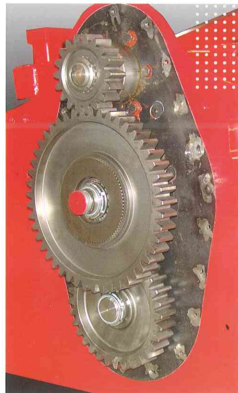
Trasmissione laterale ad ingranaggi sovradimensionati.
